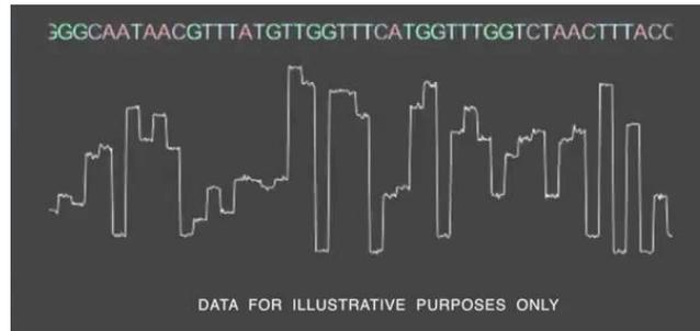
Fig. 4: Le *squiggle* est le tracé du signal mesuré par le MinION. Pour l'illustration, une séquence après *basecalling* a été ajoutée au dessus, pour une visualisation d'un véritable signal voir figure 11
